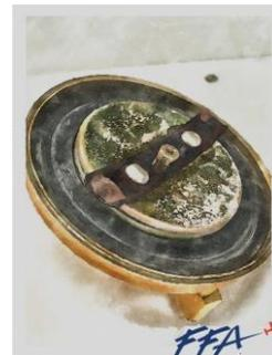
? **Problématique** : trop anticiper le retrait du bouchon de réservoir et/ou trop retarder sa remise en place peut non seulement faire oublier sa présence mais peut permettre également à des insectes volants d'entrer dans le réservoir sans que le pilote ne s'en aperçoive. Bien que ces insectes soient généralement arrêtés par le filtre à carburant, certains événements de sécurité ont néanmoins pour origine le fait que des débris d'insectes ont pu atteindre la cuve du carburateur par cette voie.
